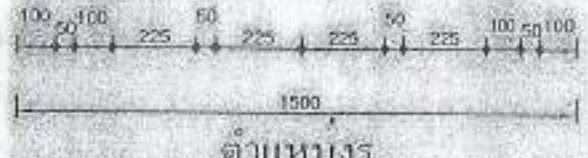
แบบคอน คอรัสป็น ขนาด 100 x 100 x 1500 มม. 1:20
