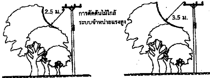
ภาพที่ 2 กรณีสายไฟฟ้าแรงสูงเป็นอลูมิเนียมเปลือย ระยะห่างต่ำสุดหลังการตัด ทุกทิศทางไม่น้อยกว่า 3.50 เมตร
