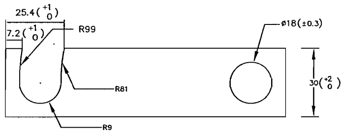
รายละเอียด C เหล็กประกับ 640x30x6 มม.
