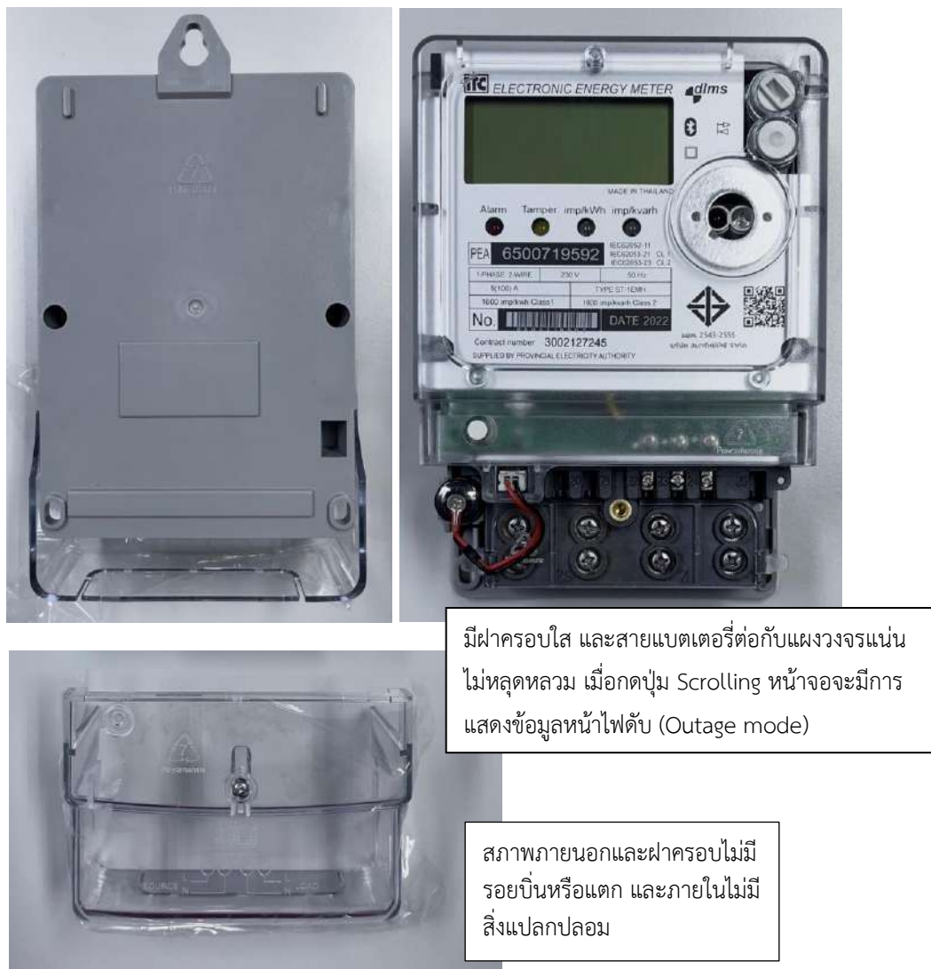
รูปที่ 6 ตรวจสอบสภาพทั่วไปภายนอก มิเตอร์อิเล็กทรอนิกส์ 1 เฟส
