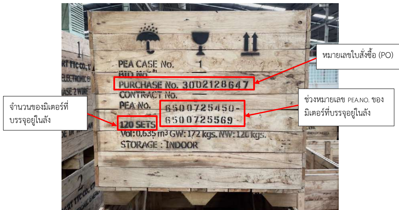
รูปที่ 1 ตัวอย่างรายละเอียดบรรจุภัณฑ์ลังไม้และการประทับตราข้างลัง (Marking)
