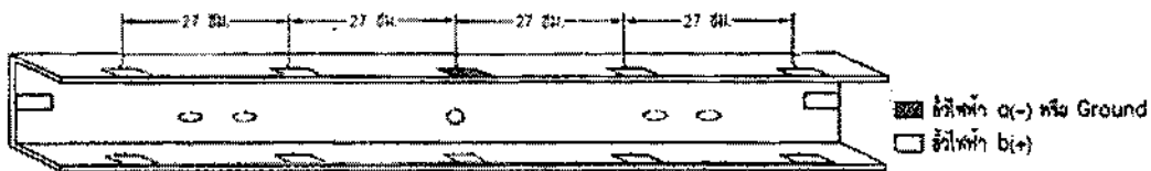
รูปที่ 1 จุดทดสอบความทนแรงดันไฟฟ้า (Dielectric Strength)
