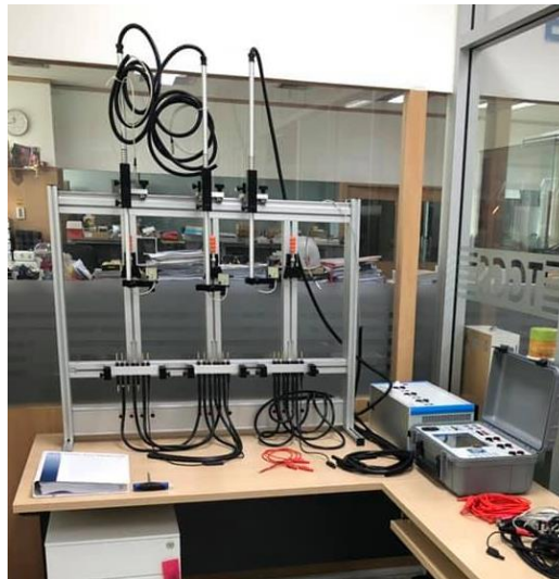
รูปที่ 4-1 Meter Test Equipment สำหรับจ่ายแรงดันและกระแสทำงานให้แก่มิเตอร์ไฟฟ้าอิเล็กทรอนิกส์
