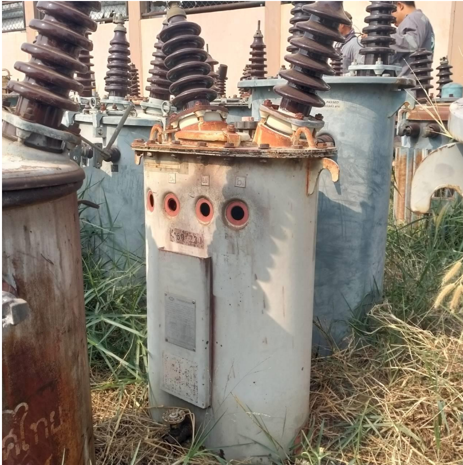
PEA TR33-003306 SN.200625886 ขนาด 20 KVA บริษัทผู้ผลิต THAIMAXWELL
