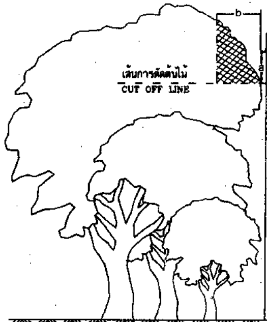
การตัดแต่งต้นไม้สำหรับสายหุ้มฉนวนเต็มพิกัดเกลียว TREE TRIMMING FOR TWISTED AERIAL CABLE.
