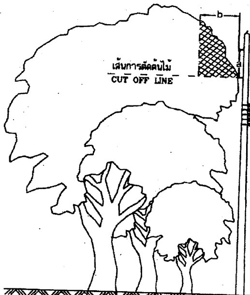
การตัดแต่งต้นไม้สำหรับสายท่อนวนเต็มพิกัดเกลียว TREE TRIMMING FOR TWISTED AERIAL CABLE.
