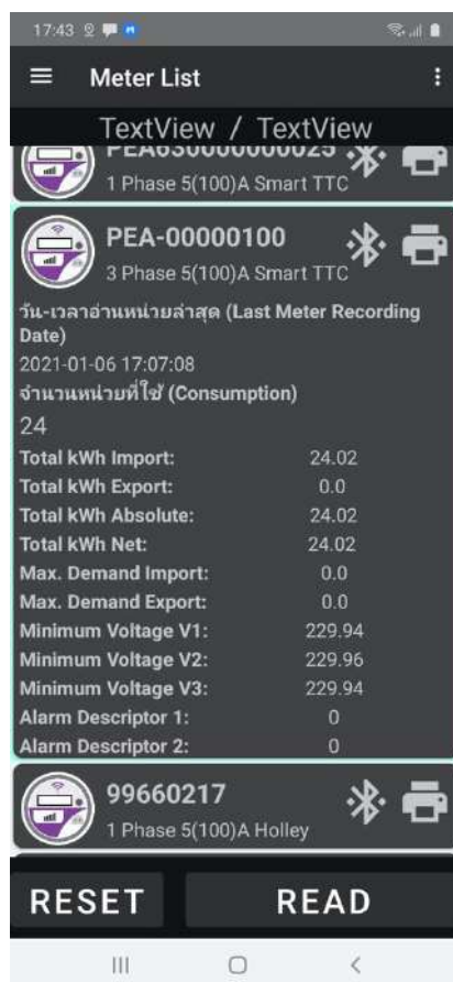
รูปที่ 4-2 ตัวอย่างหน้าจอแสดงผลการอ่านค่าได้สำเร็จ
